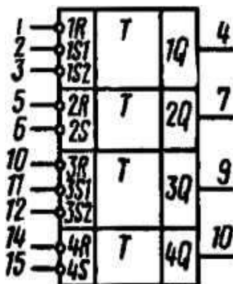
Условное графическое обозначение К555ТР2, КМ555ТР2
